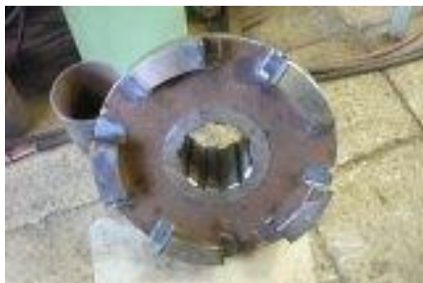
Фото 33. Закаленная поверхность муфты кулачковой (сталь 50 от 30 до 60 HRC)
