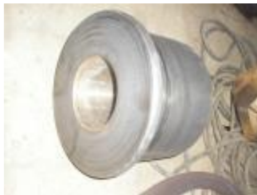
Фото 4. Закаленный ролик (сталь 34ХН1М от HB 240 до 55 HRC)
