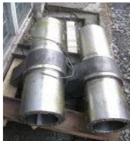
Фото 28. Закаленные кулачки на валах (сталь 38Х2Н2МА от HB 240 до HB 500)
