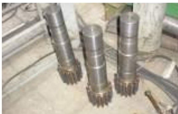
Фото 31. Закаленные вал-шестерни (сталь 30ХГСА)
