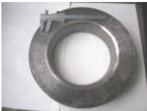
Фото 3. Закаленная внутренняя поверхность кольца пуансона (сталь 45Х1 от 48...50 до 60...62 HRC)
