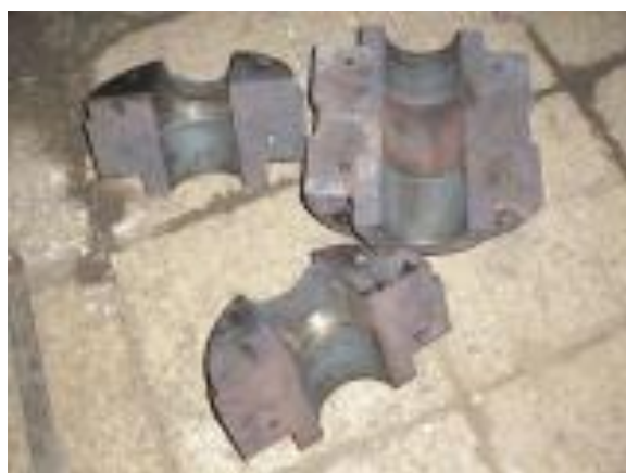
Фото 7. Закаленная внутренняя поверхность матрицы
