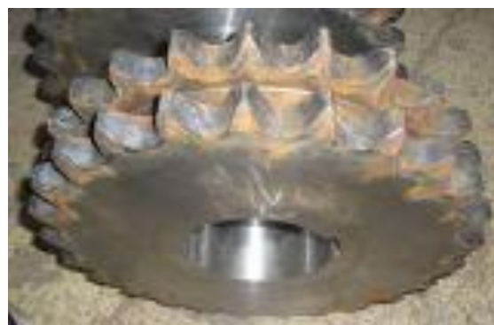
Фото 32. Закаленная звездочка (сталь 20)
