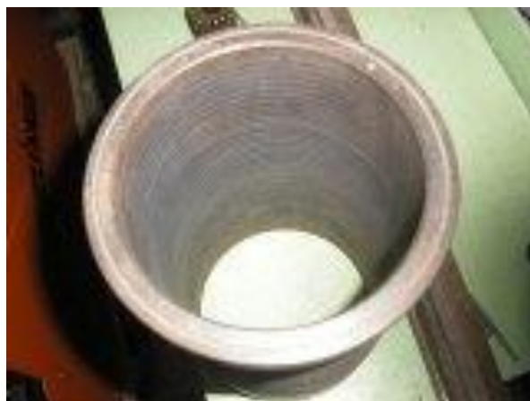
Фото 25. Закаленная изнутри чугунная гильза дизеля «КАМАЗ»
