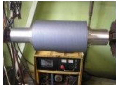
Фото 14. Закаленный валок холодной прокатки (сталь 9ХС до 60 HRC)
