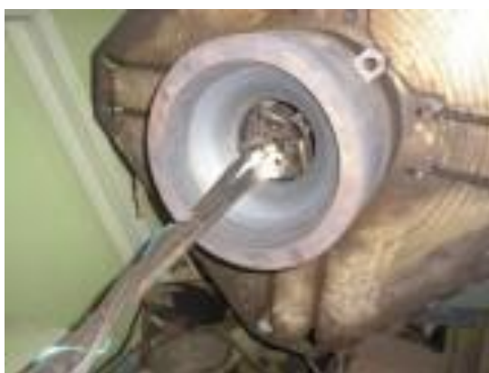
Фото 5. Закалка матрицы для холодной штамповки (сталь 40ХН от 20 до 52 HRC)
