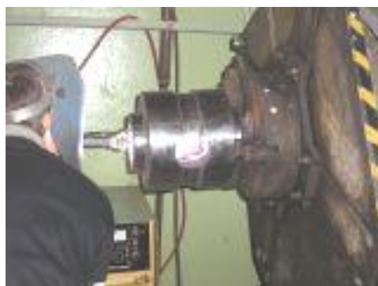
Фото 6. Закалка тройниковой матрицы для холодной штамповки (от 50 до 60 HRC)
