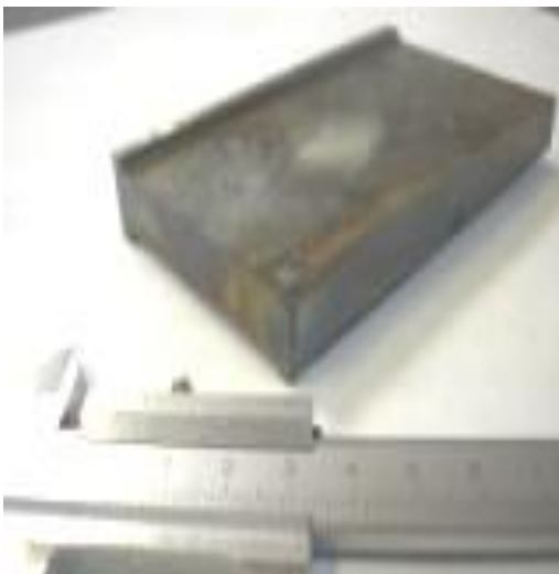
Фото 21. Закаленная лопатка дробемета (сталь 45 до 50 HRC)
