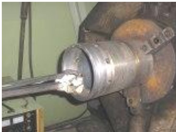
Фото 24. Закалка втулки изнутри (сталь 20 от HB 140 до 50 HRC)
