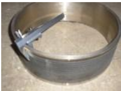
Фото 39. Закаленная тонкостенная деталь (сталь 20 до 40 HRC)
