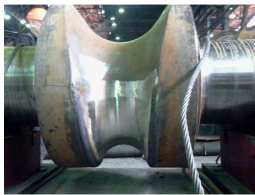
Фото 40. Закаленный валок пильгерстана (сталь 45), наплавленный Св-30Х25Н16Г7
