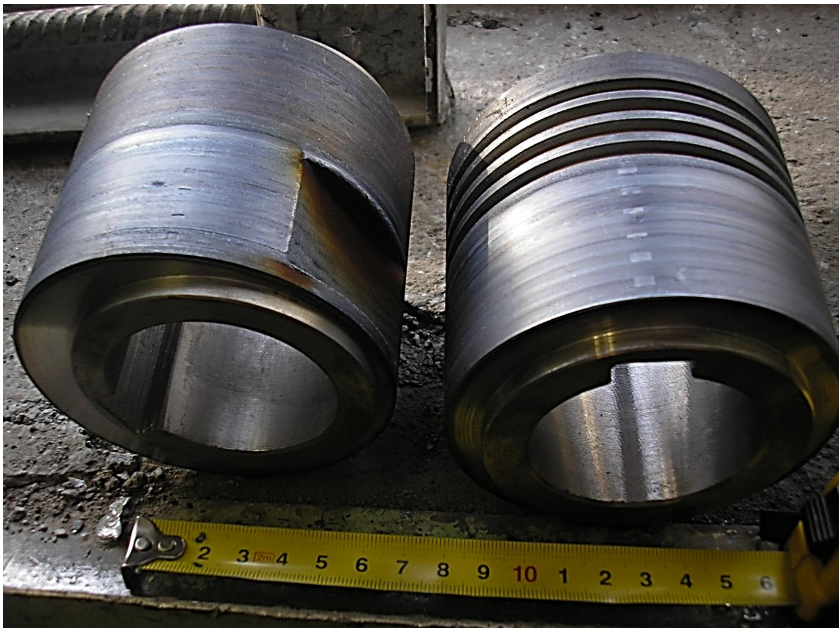
Прокатные валки, сталь 9Х1, до 55 НRC
