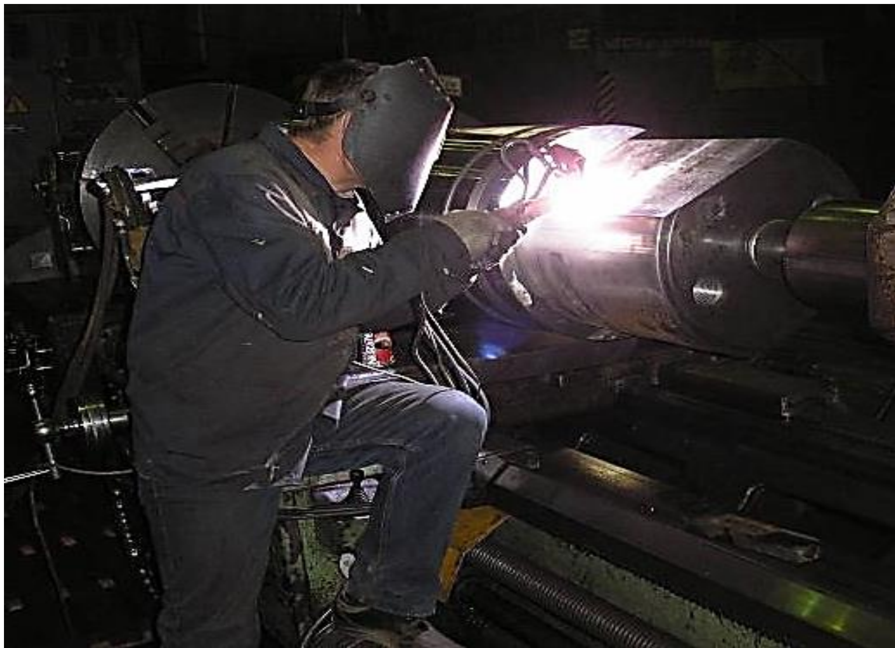
Закалка приводной части валка, сталь 34ХН3М с 22 HRC до 58 HRC
