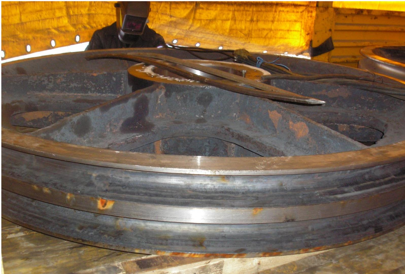
Закалка катка тележки крана, сталь 45 (от HB160 до HB 300)
