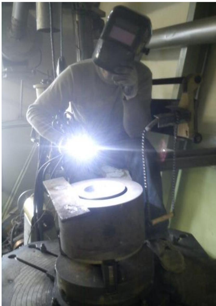
Рис. 3. Закалка штампов из стали 5ХНМ для ОАО «ПРОМКО» установкой УПЗР-1
