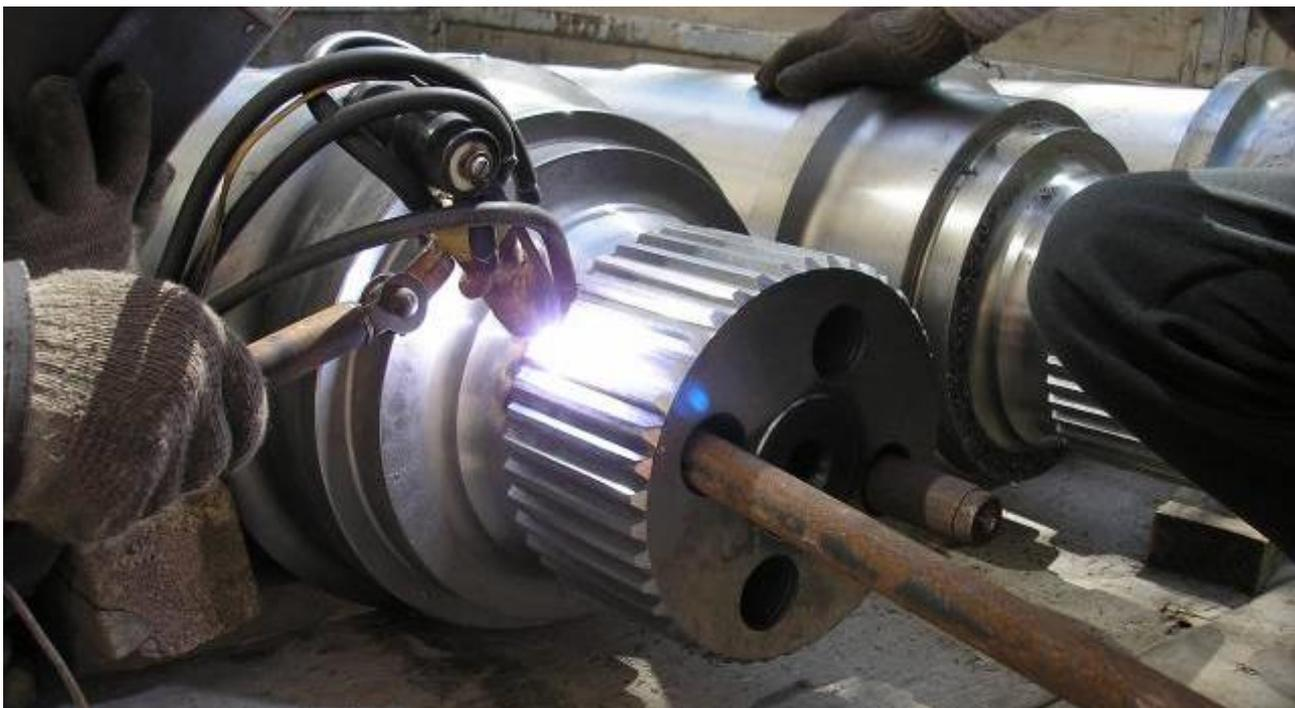
Рис. 5. Закалка шлицевых соединений эджерных валов из стали 5ХНМ для ОАО «ЕВРАЗ НТМК» установкой УПЗР-2
