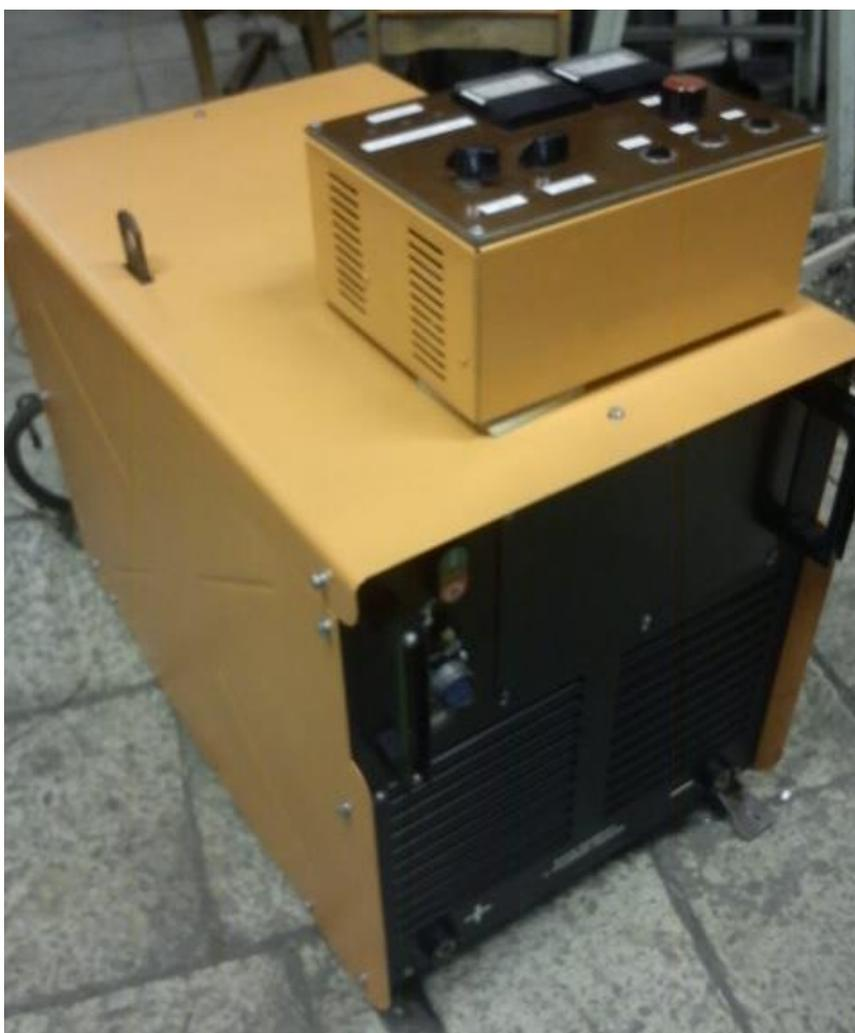
Рис. 7. Установка плазменной закалки в автоматическом режиме УПЗА-1
