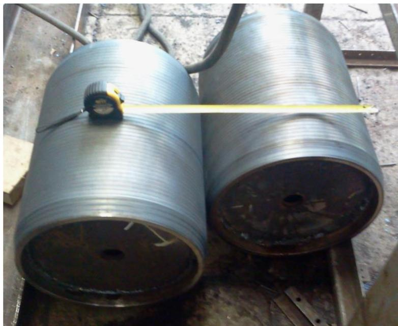
Рис. 8. Закаленные поверхности шаблонов
