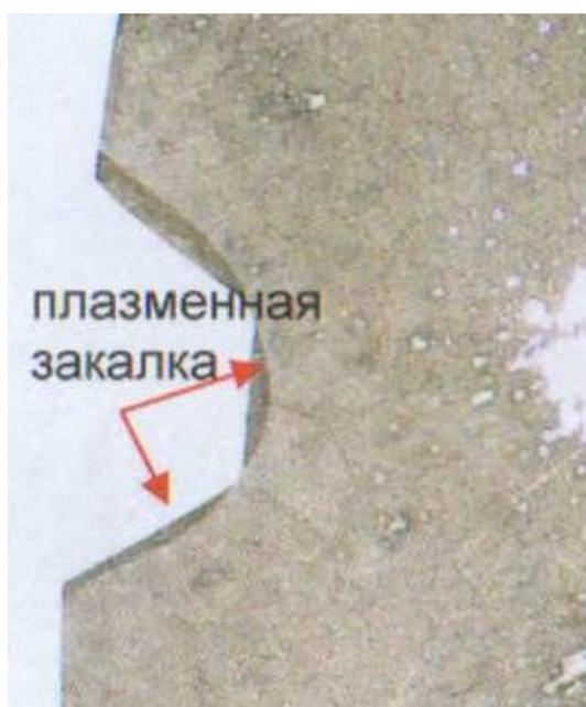
Рис. 6. Фрагмент макроструктуры шлицевых соединений после закалки установкой УПЗР-2
