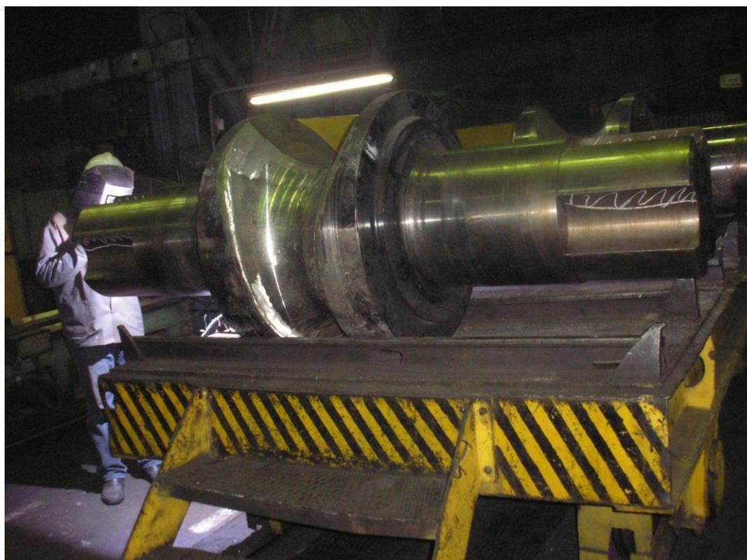
Рис. 2. Закалка валков пильгерстана на ОАО «СТЗ» установкой УПЗР-1
