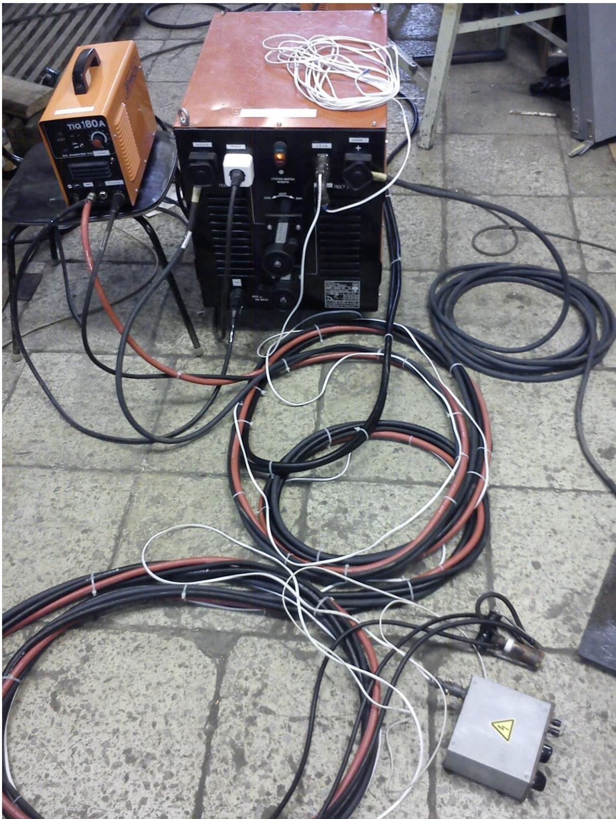
Рис. 1. Установка плазменной закалки в ручном режиме УПЗР-1
